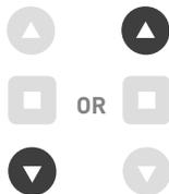
Per invertire la direzione di rotazione della tenda, tenere premuti contemporaneamente i pulsanti **SALITA** e **DISCESA** fino alla risposta del motore
